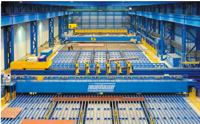
Gesteuert von der IBH macro 8005 NT werden Schiffselemente auf dem Laserschweißportal der Firma Held Systems, Deutschland, gefertigt – sie steht bei der Meyer Werft in Papenburg.
